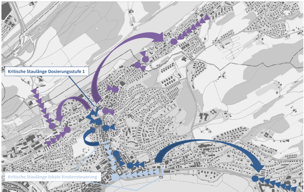
Abbildung 18: Dosierung von innen nach aussen (hellblau: lokale Knotensteuerung, blau: Dosierungsstufe 1, violett: Dosierungsstufe 3)
